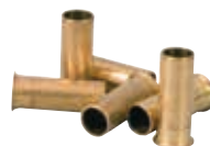
Instickshylsa Förpackning om sex. För mjukt kopparrör. 8 x 0,8 mm. Blisterförpackning.
