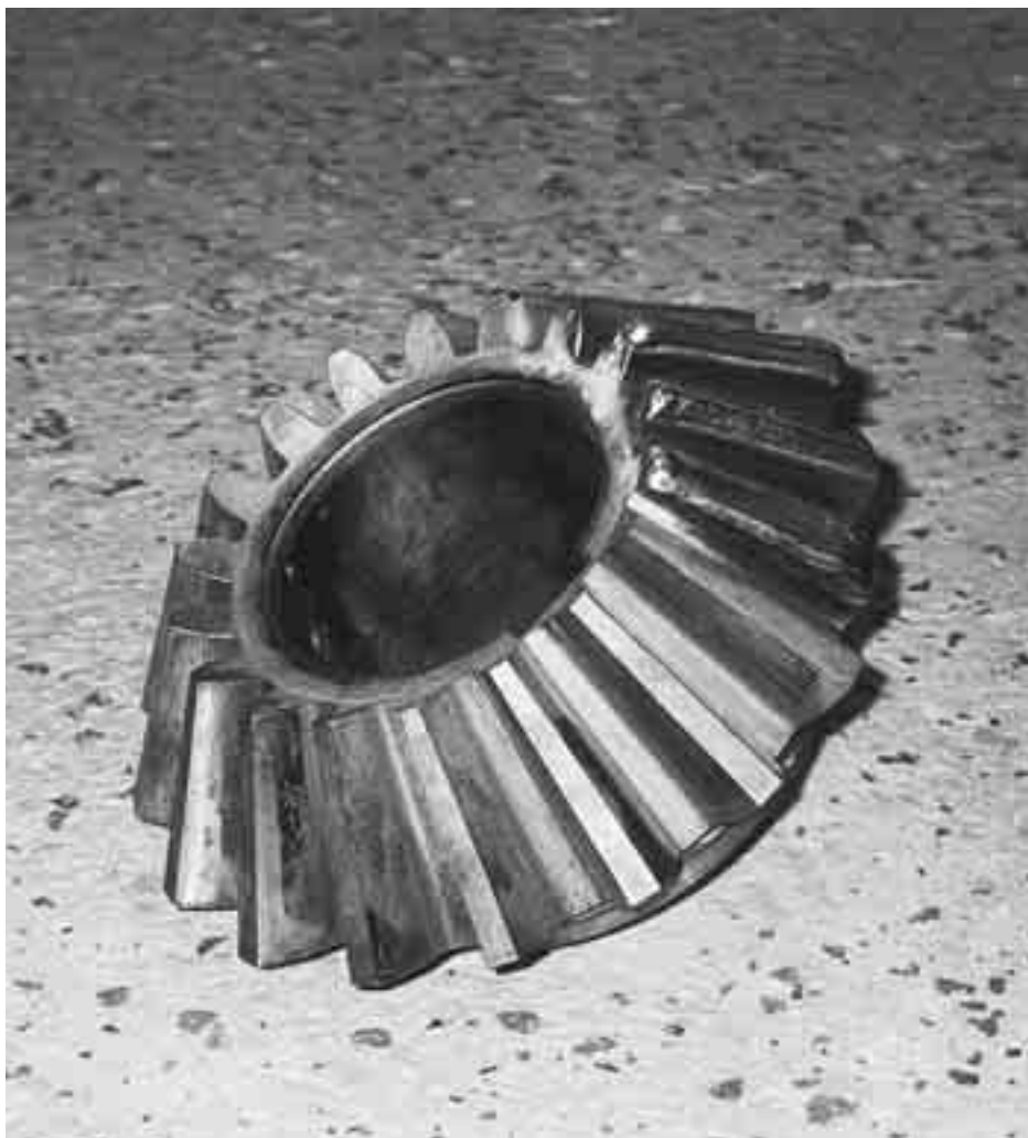
Kugghjul uppbyggt med elektroden OK 68.82.
