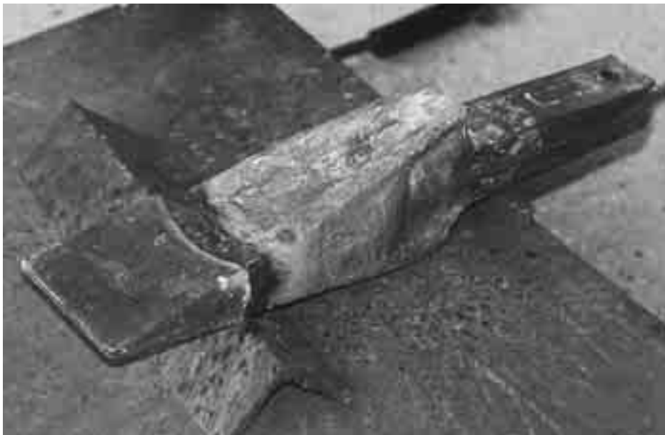
Grävskopstand försedd med ny spets med hjälp av OK 67.45 eller OK Tubrodur 14.71.
