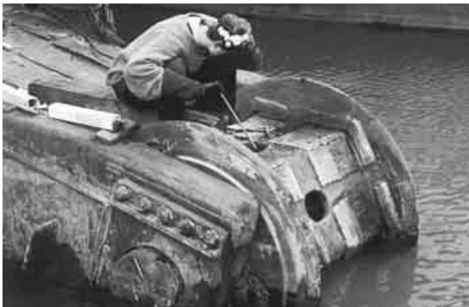
Hårdsvetsning av trumma med OK 84.84. Fyllnadssvetsning med OK 83.28.
