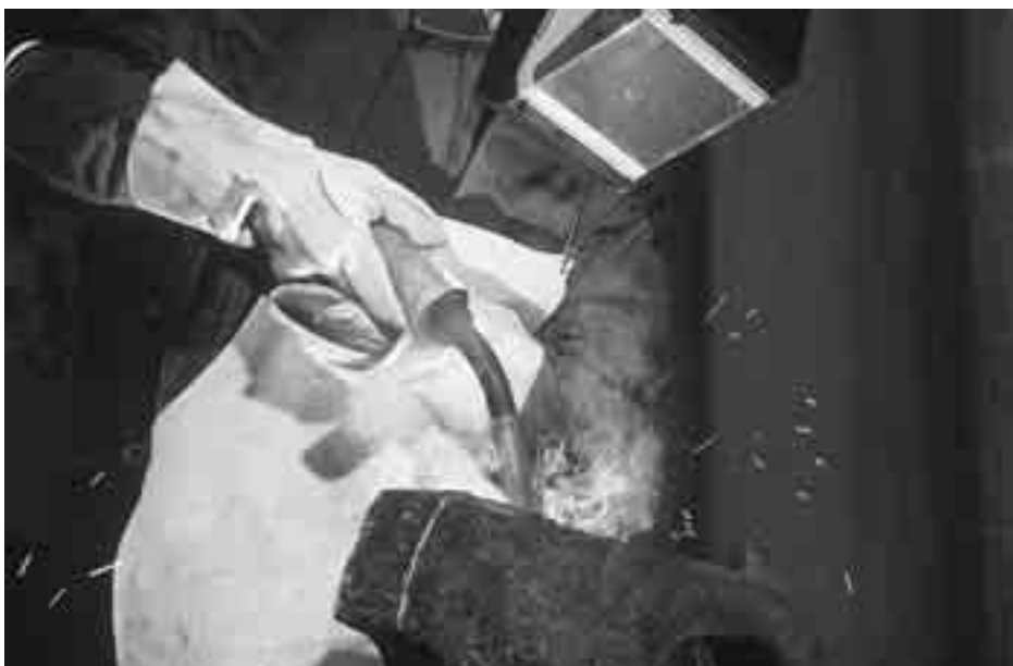
Krosshammare påsvetsad med OK Tubrodur 15.65.
