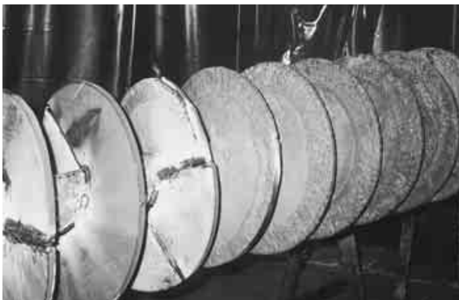
Matarskruv: Hårdsvetsning med OK Tubrodur 14.70.
