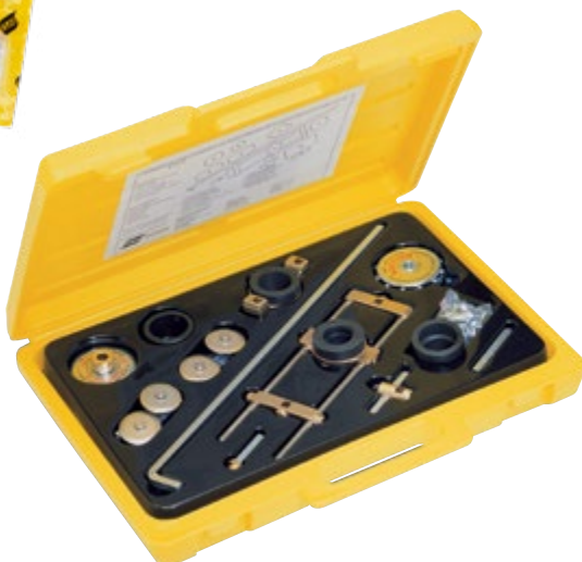
Skärstödssats, utökad, för cirkelskärning Ø 45–1060 mm. Centrum fixeras med stift, magnet eller sugkopp. Även lämplig för raka snitt.
